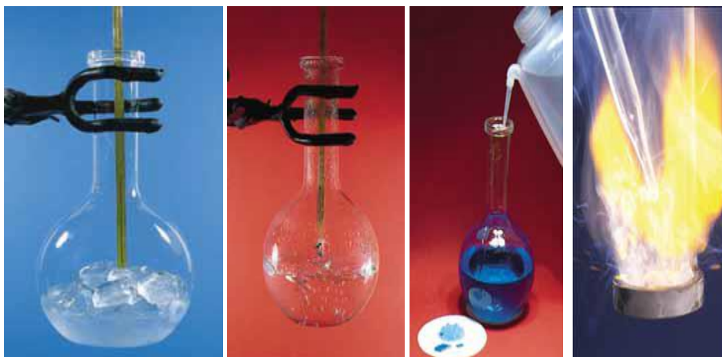
A-física. Funde a 0°C B. Física. Hierve a 100°C C. Física. Disuelve una Infinidad de sustancia Ej. sulfato de cobre (II) D. Química. Reacciona Violentemente con sodio.
