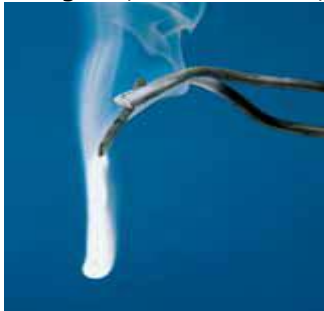
Fig. 3. Reacción de combustión del Magnesio. El magnesio se quema en oxígeno para formar óxido de magnesio: un sólido blanco. La masa de óxido de magnesio que se forma es igual a la suma de las masas de magnesio
