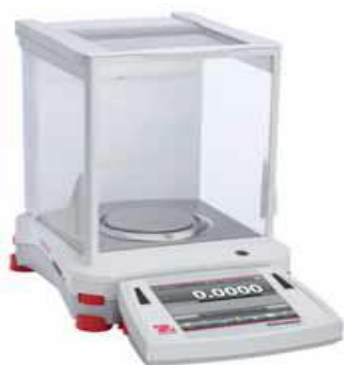
Fig. 11- Balanza analítica moderna que sirve para medir masas con aproximación de 60.0001 g. La balanza analítica se usa cuando tienen que medirse masas con mucha precisión.
