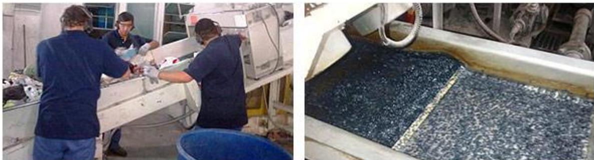
*Ejemplo de procesamiento:* Puesta en la máquina recicladora para iniciar el proceso de reciclado Pellets producto del reprocesamiento de films y bolsas plásticas.
