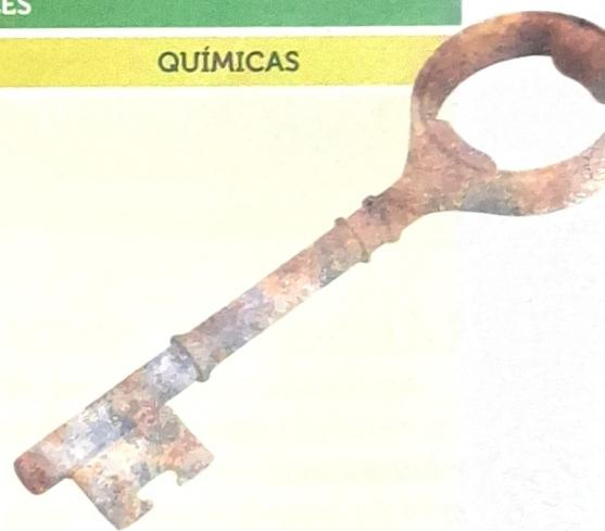
Las **propiedades químicas** se relacionan con la composición química del material y su capacidad de reaccionar químicamente con otro. Por ejemplo, el hierro se oxida fácilmente cuando reacciona con el oxígeno del aire, mientras que el oro permanece inalterable. La estabilidad química del acero inoxidable lo hace resistente a cualquier sustancia. Sin embargo, la inestabilidad del cemento hace que al combinarse con arena y agua se transforme en un sólido muy duro, óptimo para la construcción.
