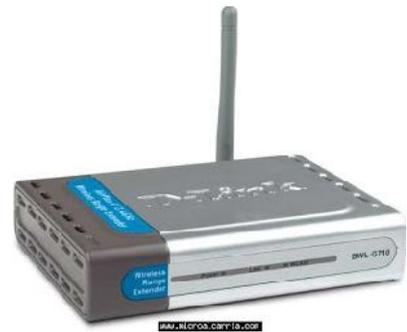
**Puente o Bridge:** es un dispositivo de interconexión de redes de ordenadores que opera en la capa 2 (nivel de enlace de datos). Este interconecta 2 segmentos de red haciendo el pasaje de datos de una red hacia otra, con base en la dirección física de destino de cada empaque.
